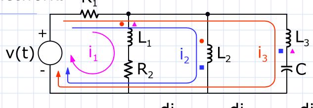
$$v(t) = R_{1}(i_{1} + i_{2} + i_{3}) + L_{1}\frac{di_{1}}{dt} + L_{12}\frac{di_{2}}{dt} - L_{13}\frac{di_{3}}{dt} + R_{2}i_{1}$$
