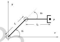
$$p = egin{bmatrix} x \ y \end{bmatrix} = egin{bmatrix} l_1 \cos q_1 &+ l_2 \cos (q_1 &+ q_2) \ l_1 \sin q_1 &+ l_2 \sin (q_1 &+ q_2) \end{bmatrix}$$
